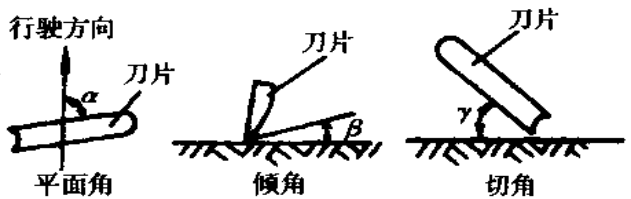
图 6.3.6 平地机刀片安装示意图
