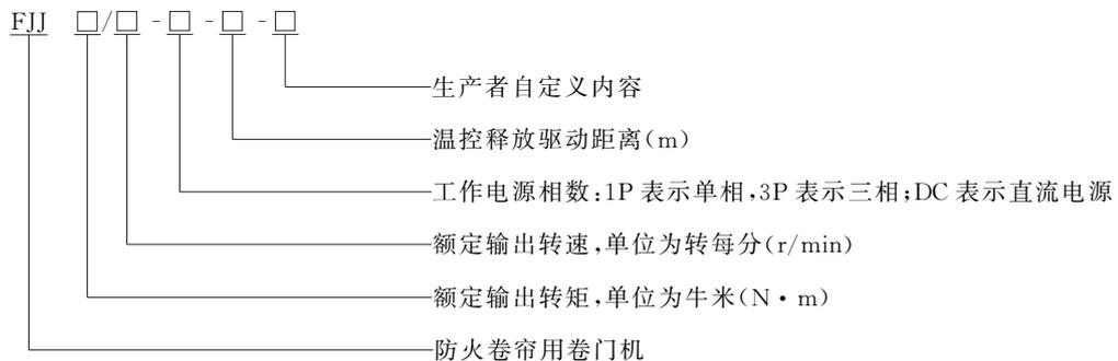
图 1 防火卷帘用卷门机型号编制
